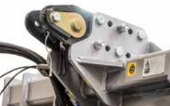
Regelbare Gegenschneide aus Hardox® für die Einstellung der Körnungsgröße
