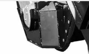
Hydraulisch regelbare Gleitkufen gestatten die Einstellung der Arbeitstiefe des Rotors und verhindert das Austreten des Materials an den Seiten
