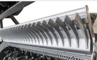
Anschraubgitter für Heckklappe gestattet die Regelung der Körnungsgröße des ausgestoßenen Materials
