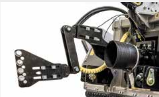
Parallelsteuerung Typ W zwischen Getriebe und Kardanwelle gestattet dem Mulcher das Arbeiten in mehreren Winkelstellungen, ohne die Zapfwelle zu schädigen
