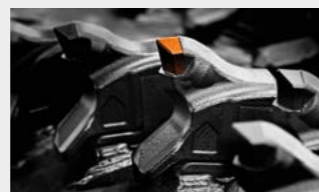
Möglichkeit, den Rotor mit verschiedenen Fräsmeißeln auszustatten
