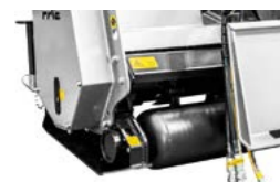
Selbstreinigende Laufwalze mit integrierter Kufe
