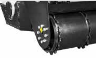
Hydraulische regelbare Laufwalze mit Abstreifer, der die Nutzung der Walze auch auf nassem Gelände gestattet
