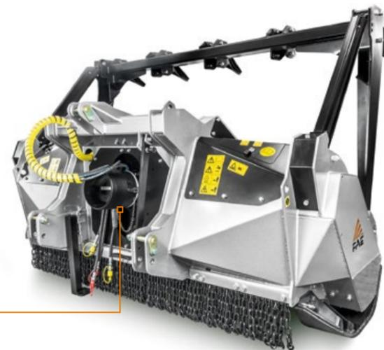
**Parallelsteuerung Typ „Z“ oder Typ „W“** zwischen Getriebe und Kardanwelle behält jederzeit den korrekten Arbeitswinkel zwischen Kardanwelle und Zapfwelle bei (Option)
