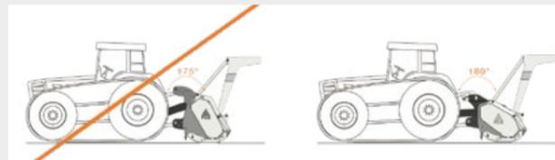
**Modell für Traktoren mit niedrig liegender Zapfwelle**
