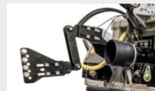
**Parallelsteuerung Typ W zwischen Getriebe und Kardanwelle** gestattet dem Mulcher das Arbeiten in mehreren Winkelstellungen, ohne die Zapfwelle zu beschädigen
