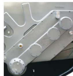
Der doppelte Zahnradantrieb reduziert die Geschwindigkeit des Rotors und somit auch den Verschleiß der Meißel
