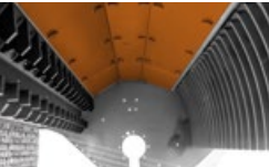
Austauschbare innere Schutzverkleidungen aus Hardox® einfache und schnelle Wartung für höchste Effizienz
