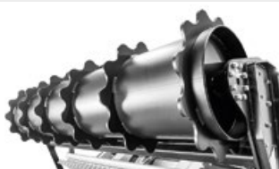
Hydraulische regelbare Laufwalze oder Breite Walze gestattet die Regelung der Körnungsgröße des ausgestoßenen Materials
