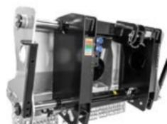
**Die hydraulische Seitenverschiebung** gestattet ein flinkes, rasches und präzises Verlagern der Fräse, so dass in unmittelbarer Nähe von Pflanzen und Kulturen gearbeitet werden kann, ohne sie zu beschädigen
