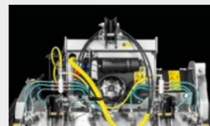
Das **Water Spray System** (Basic & High Flow) dient zum Kühlen der Werkzeuge, um ihre Widerstandsfähigkeit zu verbessern
