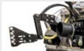
**Parallelsteuerung Typ W zwischen Getriebe und Kardanwelle**
