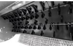
Noppengegenschneide sorgt für gleichmäßiges und feines Mulchmaterial
