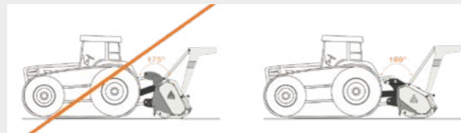
Modell für Traktoren mit niedrig liegender Zapfwelle (z.B. Raupentraktoren)
