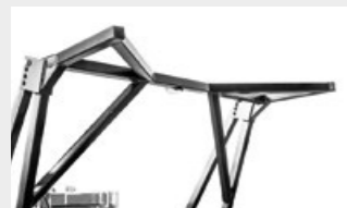
Mechanische Drückevorrichtung führt das Material vor dem Mulchen zusammen
