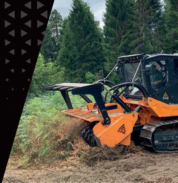
Mechanische oder hydraulische Drückevorrichtung (Option)
