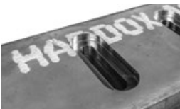
Verstellbare Gegenschneide aus Hardox® für die Einstellung der Körnungsgröße
