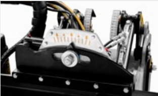
Hydraulischer Neigungsausgleich (Tilt) für direkte Steuerung aus der Kabine
