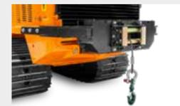
Heck-Seilwinde mit 6 Tonnen Zugkraft
