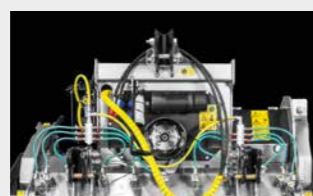
Wasserinjektionssystem WSS Basic zur Staubreduzierung und Werkzeugkühlung
