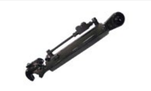
Hydraulischer Oberlenker zur optimalen Steuerung der Arbeitstiefe
