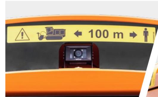
Heckkamera mit zusätzlichem LCD-Display (Service-Paket)
