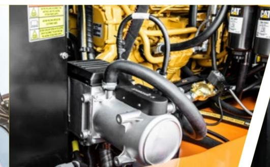
System zum Vorwärmen von Motor und Hydrauliköl
