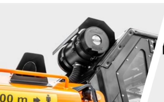
System zur Druckbeaufschlagung der Kabine
