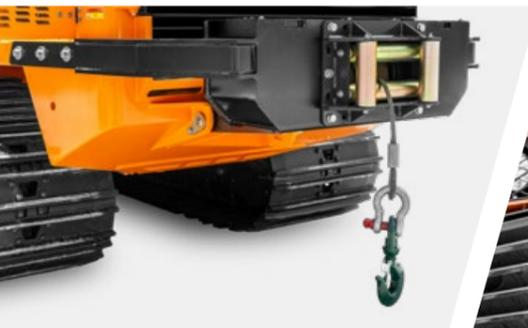
Hintere Seilwinde mit 6 Tonnen Zugkraft
