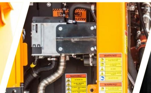
System zum Vorwärmen von Motor und Hydrauliköl
