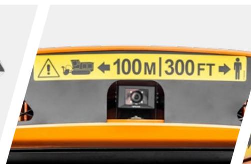
Heckkamera mit zusätzlichem LCD-Display (Paket Visibility)
