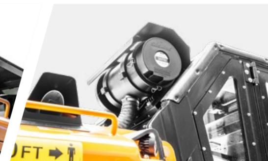
System zur Druckbeaufschlagung der Kabine
