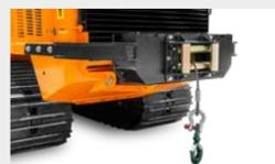
Heck-Seilwinde mit 6 Tonnen Zugkraft
