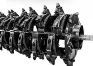
D:Mine Rotor mit G/3 Fräszähnen
