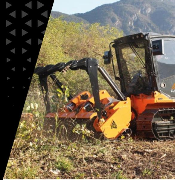
Mechanische oder hydraulische Drückevorrichtung (Option)
