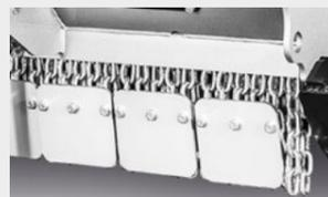
**Anschraubbare Platten für Schutzketten**
