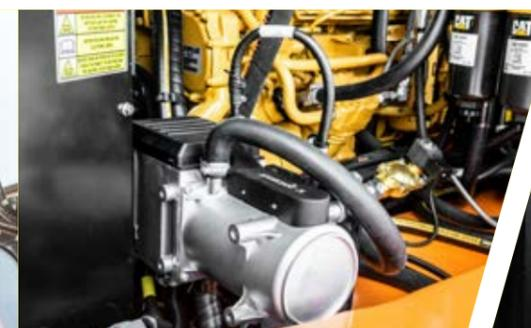
System zum Vorwärmen von Motor und Hydrauliköl
