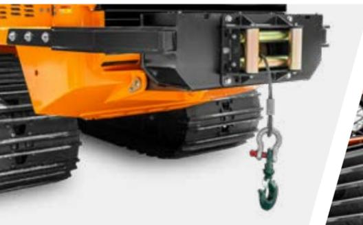
Hintere Seilwinde mit 6 Tonnen Zugkraft
