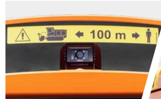
Heckkamera mit zusätzlichem LCD-Display (Paket Visibility)
