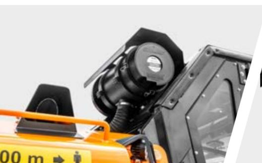
System zur Druckbeaufschlagung der Kabine
