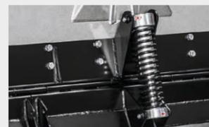
**Feder-gedämpfte Dosierklappen** zum Nivellieren und zu verdichten des zerbrochenen Materials, um eine einheitliche Basis zu schaffen
