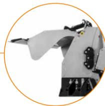
**Cámara de geometría variable** para trabajar el terreno con precisión y obtener un mezclado ideal
